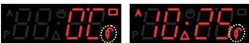
Abb.: Anzeigen wenn Bratenthermometer fehlt, bei Manuell und Automatik (Symbol Bratenthermometer „P“ blinkt)
