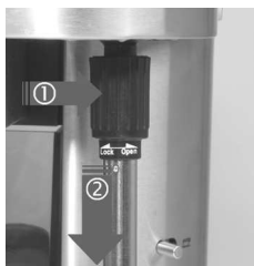
① Edelstahl-Hülse zum Abnehmen am Schaft fassen, nach rechts drehen und entriegeln. ② Anschließend die Hülse nach unten abziehen.
