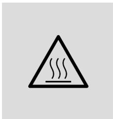
**Achtung:** Gehäuse-Oberflächen, Brühkopf, Siebträger, Filtereinsätze sowie Heißwasser-/Dampfdüse werden während des Betriebs heiß!
