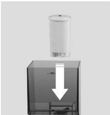
**Schritt 4:** Filterpatrone in der dafür vorgesehenen Halterung am Boden des Wassertanks fest positionieren.
