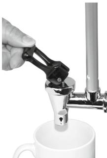
Den Griff des Ablaufhahns so drehen, dass die halbrunde Unterseite des Griffs nach vorne zeigt. Zum Ablassen der Flüssigkeit den Griff nach vorne ziehen und so lange halten, bis die gewünschte Menge bezogen wurde. Zur Beendigung den Griff loslassen, dieser geht automatisch in die senkrechte Position zurück und verschließt den Ablaufhahn.
