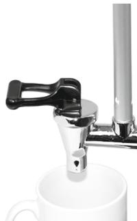
Den Griff des Ablaufhahns so drehen, dass die rechtwinkelige Unterseite des Griffs nach vorne zeigt. Zum permanenten Ablassen der Flüssigkeit den Griff nach vorne ziehen und einrasten lassen. Der Ablauf bleibt so lange offen, bis der Griff des Ablaufhahns manuell in senkrechte Position gebracht wird, um den Hahn zu verschließen.
