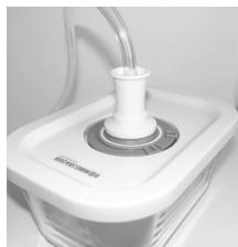
Hiermit können die VCG 1 Behälter mit allen Rommelsbacher Balken-Vakuumierern genutzt werden. Schließen Sie den Schlauch-Stecker an den Behälter-Anschluss des Vakuumierers, drücken Sie den Absaug-Anschluss leicht auf das Behälterventil und starten Sie dann die Behälter-Funktion am Vakuumierer. Viele Geräte anderer Hersteller haben einen kompatiblen Schlauch-Anschluss, hier kann der Schlauch-Adapter ebenfalls genutzt werden. Ggf. muss das Reduzierstück abgezogen werden.
