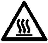
**Attention – Risque de brûlure ! En fonctionnement il y a des surfaces chaudes (boîtier, élément de chauffe, filtre permanent, réceptacle à friture, graisse/huile et autres parties) existant aussi pour l'instant après l'appareil est mis hors service. En ouvrant le couvercle veillez à la vapeur sortant!**
