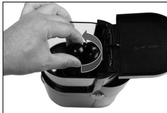
**HINWEIS:** Beim Ein- und Ausbauen des Mahlstempels kann sich die Einstellung des Mahlgrades verändern. Dies können Sie verhindern, indem Sie beim Lösen oder Festdrehen des Mahlstempels den Drehwähler für den Mahlgrad festhalten. So verhindern Sie ein Verstellen der Mahlgradeinstellung!
