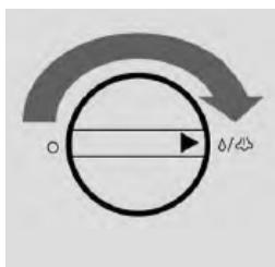
**Шаг 8:** (удаление воздуха) начать подачу горячей воды. Поверните поворотную ручку вправо. Прибор должен подавать горячую воду, пока не пойдет вода без воздуха.
