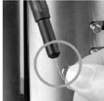
Выпускное отверстие дюзы для горячей воды /пара тщательно очистите!
