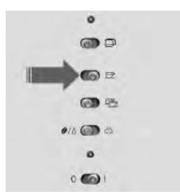
**Шаг 4 с:** (прогревание системы) начать процесс подачи на 1 чашку. Быстро нажать на переключатель. После подачи прибор автоматически остановится.
