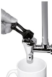
Поверните рукоятку спускного краника в такое положение, чтобы полукруглая нижняя сторона рукоятки указывала вперед. Для выливания жидкости потяните рукоятку вперед и держите до тех пор, пока не нальется желаемое количество. Чтобы окончить процесс, отпустите рукоятку, она автоматически вернется в вертикальное положение и закроет спускной краник.
