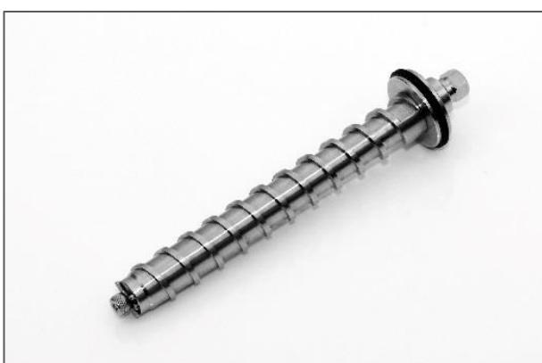
Дополнительный шнек с винтом, оптимизированным для более мелких семян (маркирован красным уплотнительным кольцом) особенно подходит для твердого продукта для прессования с мелкими зернами. Из-за более маленького винта транспортируется меньшее количество семян. Так обеспечивается оптимальная выжимка при более низкой температуре и сниженной потребляемой мощности мотора.
